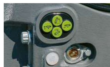
Externí ovládání pro čelní zvedací závěs a jeden rozvaděč s vybavením CEBIS.
