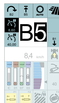
Inteligentní volba převodu na displeji v A sloupku u verze CIS.
