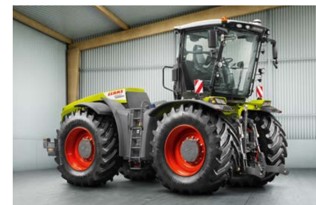
TRAC VC disponuje nejkomfortnějším řešením otočného řízení na trhu. Jeho kabina se otočí během méně než 30 sekund o 180°.
