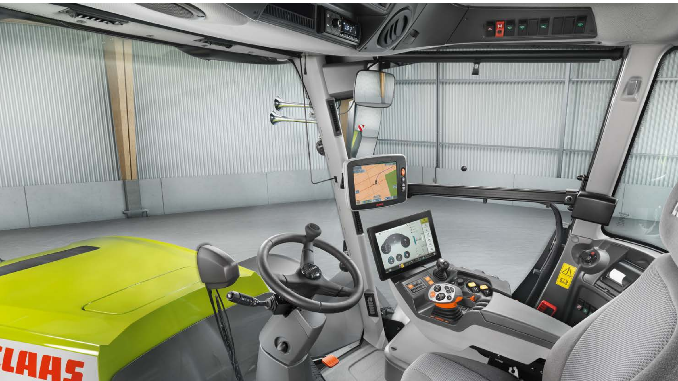
TRAC VC disponuje nejkomfortnějším řešením otočného řízení na trhu. Jeho kabina se otočí během méně než 30 sekund o 180°.
