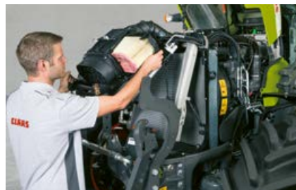
Vzduchový filtr motoru je instalován před chladiči a snadno se čistí.
