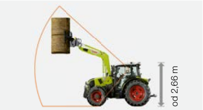
Kabina PANORAMIC s průběžným čelním sklem ke skleněné střeše: světlá výška až 2,66 m.
