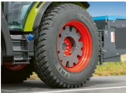
Levé zadní kolo lze dotížit hmotností až 270 kg, aby se vyrovnala hmotnost ramene výložníku. Na silnici vždy stabilní a bezpečný.
