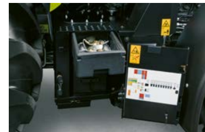
NOVINKA: Na pravé straně u nástupních schodků najdete dobře přístupnou baterii, přihrádku na náradí a přípojku stlačeného vzduchu.
