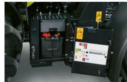
NOVINKA: Na pravé straně u nástupních schodků najdete dobře přístupnou baterii, přihrádku na náradí a přípojku stlačeného vzduchu.
