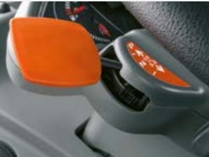
K dispozici řadicí páka pro změnu směru jízdy REVERSHIFT s elektronickou parkovací brzdou.
