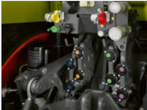
Vzduchová brzdová soustava s vysoušečem vzduchu.
