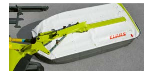
Odjištění mechanické pojistky při najetí na překážku: stroj se v případě kolize vyhne směrem dozadu a mírně nahoru (u modelu DISCO 1100 TREND je při najetí na překážku k dispozici hydraulická nonstop pojistka).
