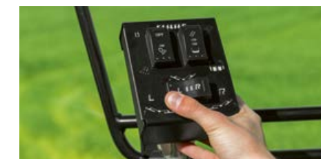
Pro model DISCO 1100 TREND je k dispozici praktická ovládací jednotka pro zdvih jednotlivých žacích jednotek, sklopení v přepravní pozici a volitelné zapínání a vypínání pracovních světlometů.
