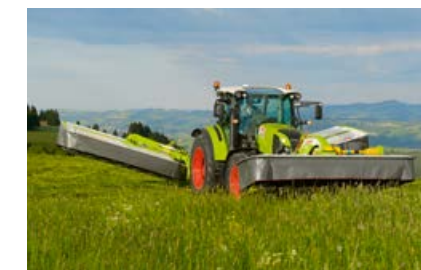
Díky kompaktnímu zavěšení v předních ramenech disponuje žací stroj na souvratí velkou světlostou výškou.
