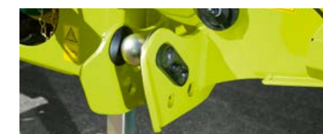
Vodící kulisy dolního táhla pro pohodlné připojení.
