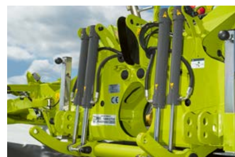
Sériově dodávané válce pro zdvih a odlehčení systému odlehčení ACTIVE FLOAT zaručují výsledek šetrný k travnímu drnu.
