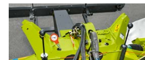
Manometr ke snadnému nastavení tlaku na povrch pole pro obě žací jednotky.
