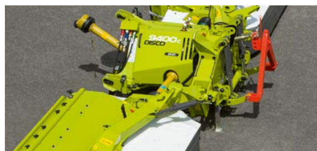
Ochrana díky hydraulické nonstop pojistce při najetí na překážku v případě kolize: Žací jednotka se vychýlí a zase se vrátí do výchozí polohy.
