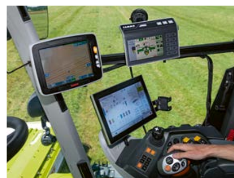
Pohodlné ovládání, například přes různé terminály ISOBUS a funkční tlačítka ISOBUS na jízdní páce.
