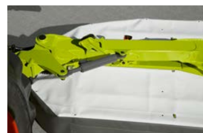
Ochrana díky hydraulické nonstop pojistce při njetí na překážku v případě kolize – žací jednotka se vychýlí a samostatně se uloží do výchozí polohy.
