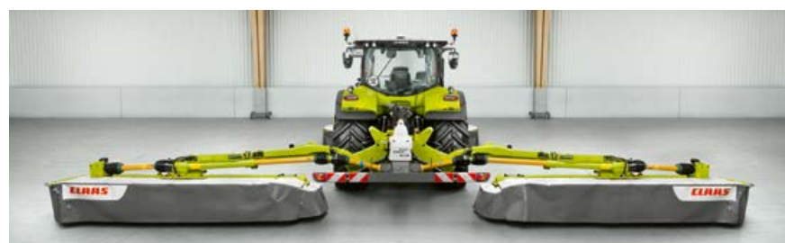
Dvě hydraulicky ovladatelná teleskopická ramena s plynulým nastavením pro optimální překrývání u modelu DISCO 1100 TREND.
