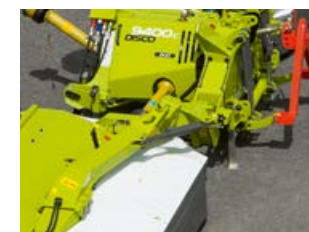
Ochrana díky hydraulické nonstop pojistce při najetí na překážku v případě kolize: Žací jednotka se vychýlí a zase se vrátí do výchozí polohy.
