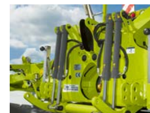
Sériově dodávané válce pro zdvih a odlehčení systému odlehčení ACTIVE FLOAT zaručují výsledek šetrný k travnímu drnu.
