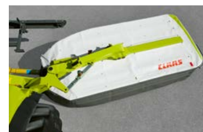
Odjištění mechanické pojistky při najetí na překážku: stroj se v případě kolize vyhne směrem dozadu a mírně nahoru (u modelu DISCO 1100 TREND je při najetí na překážku k dispozici hydraulická nonstop pojistka).
