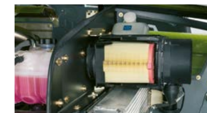
Vzduchový filtr motoru je velmi dobře přístupný a jeho údržbu lze provádět bez použití náradí.
