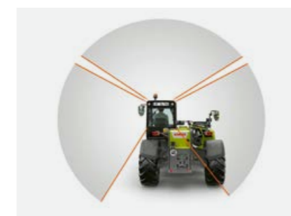
Neomezený výhled směrem dozadu pro vyšší pracovní bezpečnost díky hluboko uloženému teleskopickému rameni.
