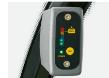
Zobrazení zatížení s jednoznačnou světelnou symbolikou: Je-li překročena hranice stability, rozsvítí se všechny diody a zazní tón alarmu.
