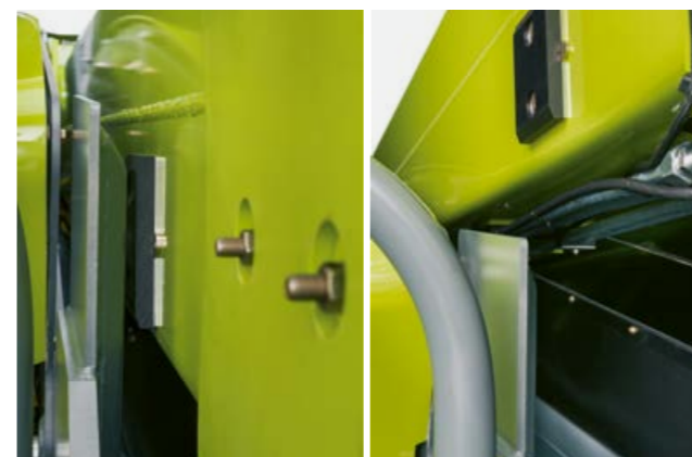
Boční vedení výložníku sériově u modelů SCORPION 756 / 746.
