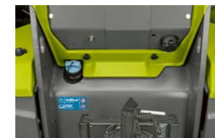
Dobře přístupné plnicí hrdlo AdBlue pro efektivní následné zpracování výfukových plynů.
