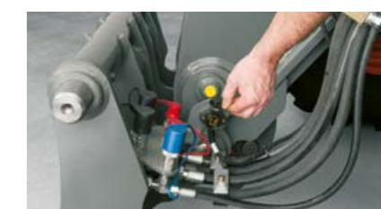
Zásuvky pro flexibilní přívod elektřiny pro nejrůznější pracovní náradí a připojená náradí.
