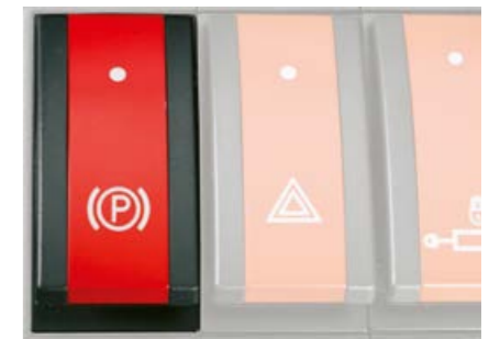
Parkovací brzda může být kolébkovým spínačem aktivována manuálně.
