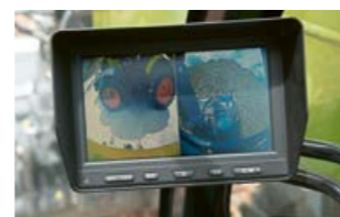
Obrazy přední a zadní kamery jsou přenášeny na monitor v kabině.
