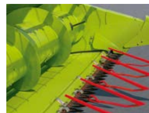
Zasunutí stolu žacího ústrojí – obilí (– 100 mm).
