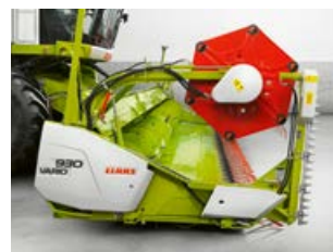
Vysunutí stolu žacího ústrojí – s řepkovými děliči (+ 600 mm).
