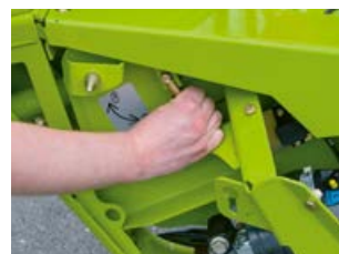
Zajištění děličů a dělicí kosa pro sklizeň řepky bez použití nářadí pomocí rychloupínání.
