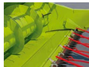
Vysunutí stolu žacího ústrojí – obilí (+ 100 mm).
