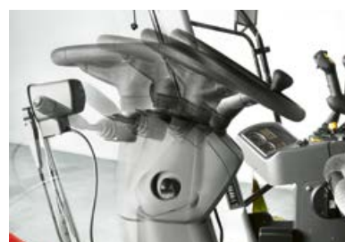
Sloupek řízení je nastavitelný ve třech rovinách.
