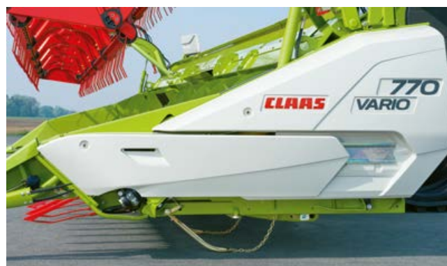
Třímenový hmatač přímo za kosou detekuje polohu žacího ústrojí.
