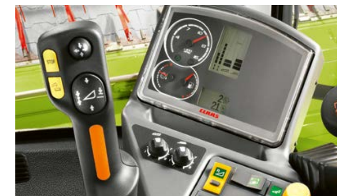
AUTO CONTOUR aktivujete jednoduše tlačítkem pro regulaci výšky, umístěným na multifunkční páce.
