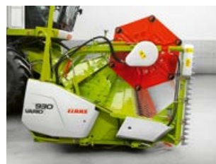
Zasunutí stolu žacího ústrojí – s řepkovými děliči (+ 450 mm).
