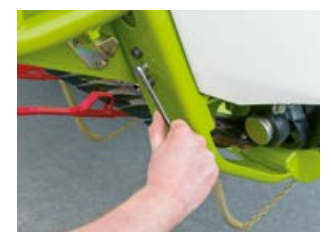
Snadné přestavení výšky děliče pomocí klápkového klíče.
