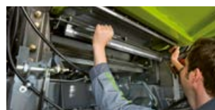
Samočinně vyprazdňovací žlab lapače kamenů.
