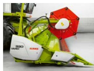
Vysunutí stolu žacího ústrojí – obilí (+ 600 mm).
