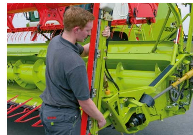
Připojení bočního řepkového děliče rychloupínáním.
