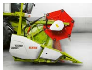
Zasunutí stolu žacího ústrojí – obilí (- 100 mm).
