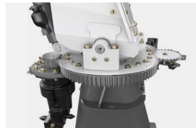
Robustní ozubený věnec pro sklizně zejména ve svazích nebo při vysoké rychlosti.
