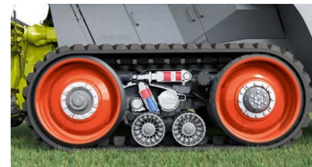
100% styčné plochy: Vodící kolo pásu má plný kontakt s půdou.
