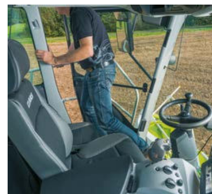
Spínač kontaktu sedadla automaticky vypne sklizňový adaptér a hlavní pohon.
