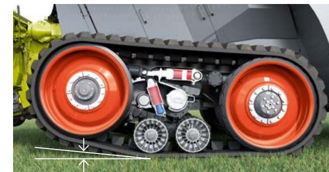
66% styčné plochy: Vodící kolo pásu je zvednuté až na 100 mm
