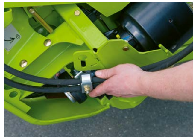
Snadné připevnění hydraulických hadic pro pohon řepkových děličů
