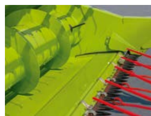
Vysunutí stolu žacího ústrojí – obilí (+ 100 mm)
