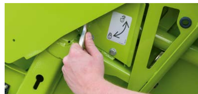
Zajištění dělice bez použití nářadí přes rychloupínání
