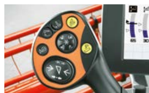
Automatické žací ústrojí aktivujete jednoduše tlačítkem pro regulaci výšky, umístěném na multifunkční páce
