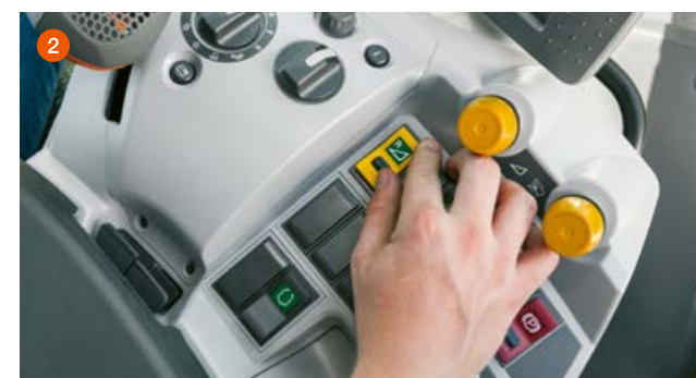
Možná reverzace vkladacího ústrojí s CMOTION (1) nebo s kolébkovým spínačem (2)
