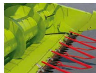
Zasunutí stolu žacího ústrojí – obilí (- 100 mm)
