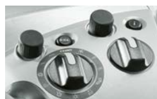
Ovládací spínače systému CEBIS a HOTKEY
