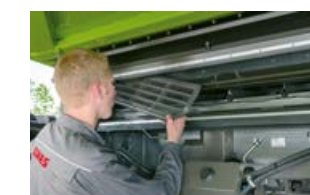
Rychlejší výměna segmentů díky koši MULTICROP
