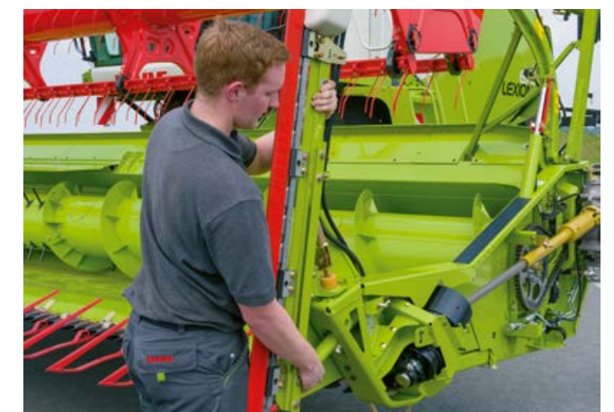
Připojení řepkového děliče přes rychloupínání
