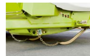
Třímenové hmatače zachycují pozici adaptéru
