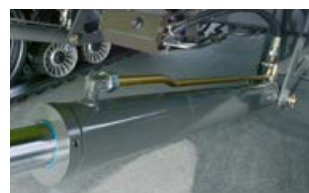
Dvojčinné válce žacího ústrojí regulují přesně tlak na podložku
