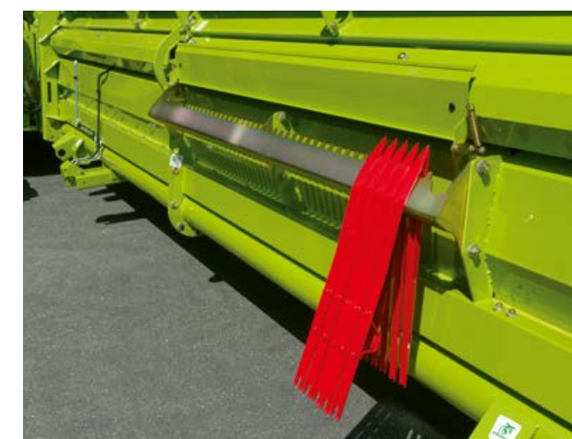
Praktické uchycení pro přídavné zvedáky na žací ústrojí
