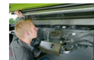
Velký lapač kamenů lze snadno otevírat ze strany a vyprazdňuje se automaticky
