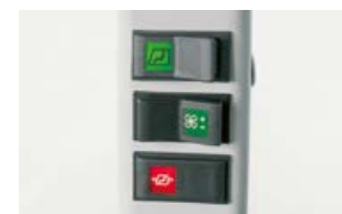
Údaje o stavu systému kabinového filtru a také aktivace a regulace ventilátorů v pohodlném dosahu na sloupku E.
