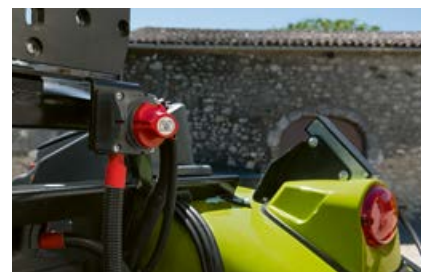
Odpojovač baterie se nachází na zadním dílu kabiny a je snadno dostupný.
