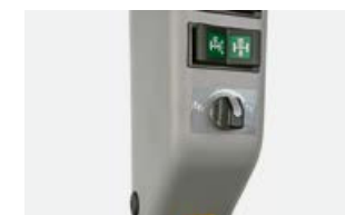
Jednoduché přestavení režimu pro odpružení přední nápravy na sloupku B.
