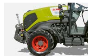
Sklopný přední zvedací závěs umožňuje díky nízkému přesahu bezpečné otáčecí manévry na souvrati.
