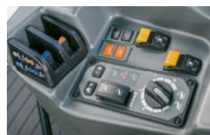
Máte na výběr mezi mechanickou a elektronickou regulací zadního zvedacího závěsu. Obě jsou ergonomicky umístěny vhodně napravo vedle sedadla řidiče.
