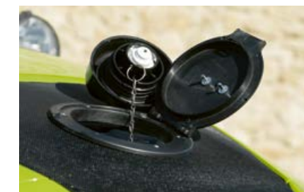
Praktická je také vysoko otevíratelná kapota motoru. Tak lze snadno otevřít a plnit chráněnou nádrž nacházející se pod kapotou.
