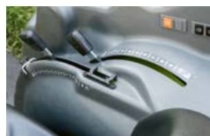
Máte na výběr mezi mechanickou a elektronickou regulací zadního zvedacího závěsu. Obě jsou ergonomicky umístěny vhodně napravo vedle sedadla řidiče.
