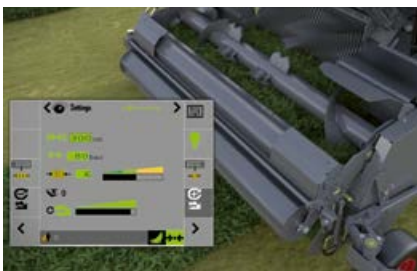
Hydraulický systém vkládání lze nastavit pohodlně ze sedadla řidiče traktoru.
