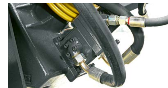
Dvě olejová čerpadla zásobují vstupní převodovku a systém čištění uzlovačů TURBO FAN hydraulickým olejem.
