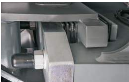
Gumové tlumiče ve výkyvném kloubu zvyšují pracovní komfort.
