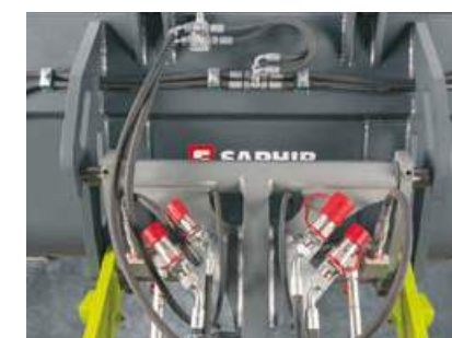
V přední části volná zpátečka a dodatečné vedení pro únik oleje s připojením k nosiči nářadí. (644 / 537)
