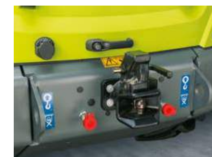
TORION 956 SINUS volitelně s volnou hydraulickou zpátečkou v zadní části.
