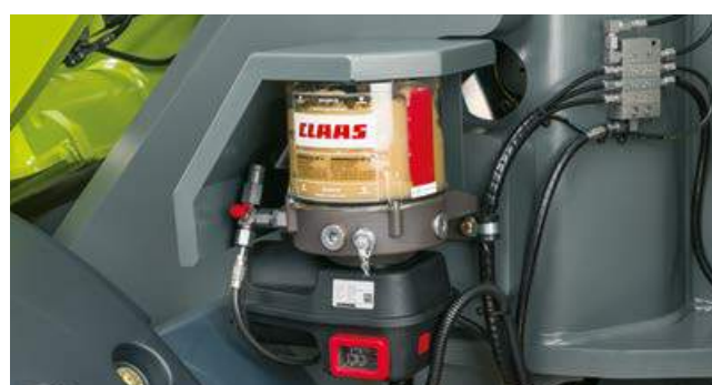
Zásobník maziva centrálního mazání leží na levé straně stroje.
