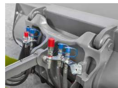
Všechny okruhy jsou dobře přístupné a chráněné na držáku nářadí. (956)
