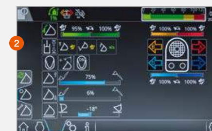
Ohraničení výšky zdvihu a hloubky spouštění je zobrazené na 9-palcovém dotikovém displeji
