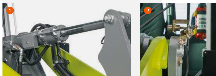
Paměť polohy lopaty (1) a omezení zvedací výšky (2) jsou mechanicky nastavitelné pro každé pracovní nářadí individuálně.
