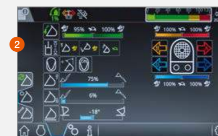
Ohraničení výšky zdvihu a hloubky spouštění je zobrazené na 9-palcovém dotikovém displeji
