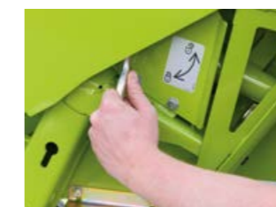
Zajištění děliče bez použití nářadí přes rychloupínání
