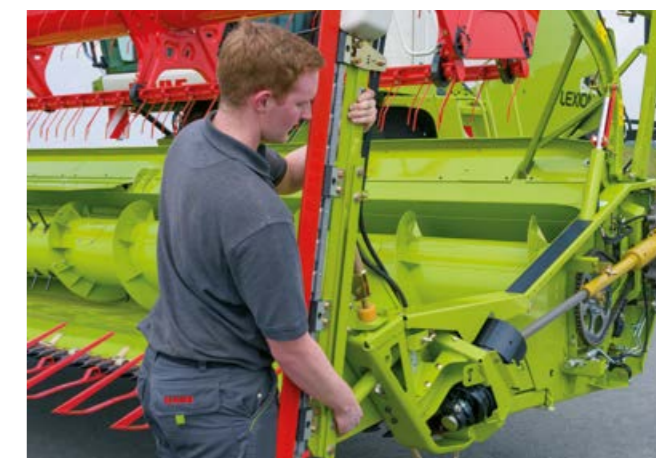
Připojení řepkového děliče přes rychloupínání
