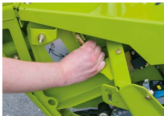
Zajištění děličů a dělicí kosa pro sklizeň řepky bez použití náradí pomocí rychloupínání
