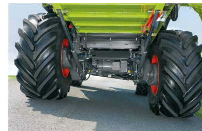
MONTANA přední náprava s maximálním vychýlením
