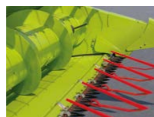
Zasunutí stolu žacího ústrojí – obilí (-100 mm)
