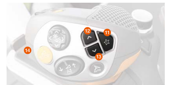
Ovládací páka CMOTION: oblíbená volba (11), oblíbená volba nahoru (12), dolů (13), nastavení hodnot pomocí tlačítka (14)
