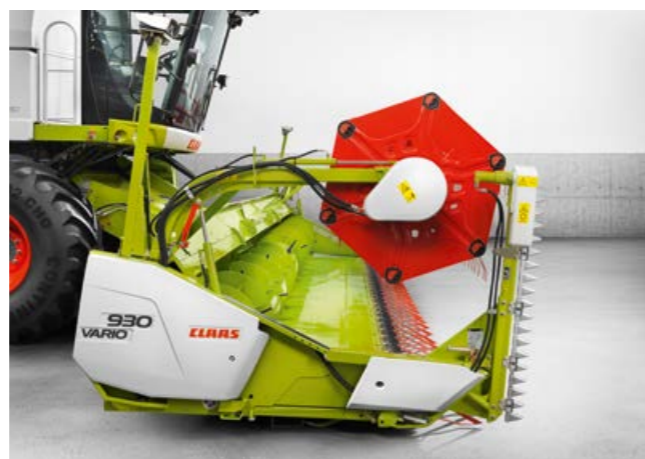
Vysunutí stolu žacího ústrojí – s řepkovými děliči (+ 600 mm)
