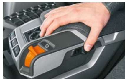
Výška loketní opěrky se dá nastavit. Dá se posunout i dopředu a dozadu.
