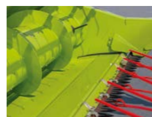
Vysunutí stolu žacího ústrojí – obilí (+100 mm)
