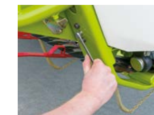
Snadné přestavení výšky děliče pomocí klapkového klíče
