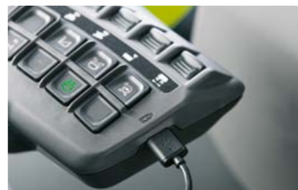
Pro mobilní koncová zařízení je k dispozici 12 V USB připojení.
