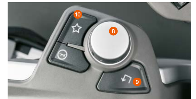
Ovládací pole CEBIS: ovladač (8), tlačítko Escape (9), správa oblíbených položek (10)
