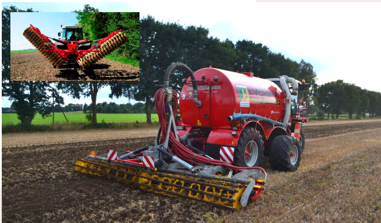
Obrázok 24: Nesený podmietač Väderstad CARRIER
