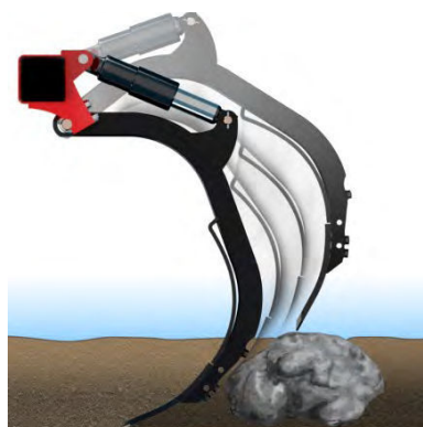
Obrázok 17: Vypínací tlak radličiek nastaviteľný až do 700 kg
