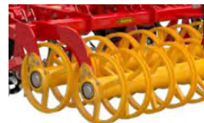
Obrázok 14: Dvojradowý valec s kolesami s U-profilom „Double SoilRunner“ vhodný pre prácu pri vysokej vlhkosti pre pôdy bez hrúd s efektom utuženia v pásoch a iba tesne pod povrchom
