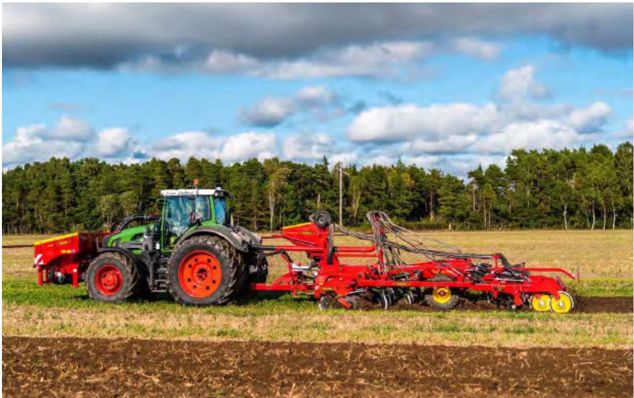
Obrázok 26: TopDown s čelným zásobníkom so sadou na hnojenie a s čelným BioDrillom
