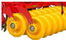
Obrázok 13: Oceľový valec „SteelRunner“ rozdelený do 2-radov s väčším priestorom medzi „diskami“ vhodný pre stredné-ťažké pôdy hrudovité suché, ale aj pre extrémne vlhké (valec s vysokou čistiacou schopnosťou)
