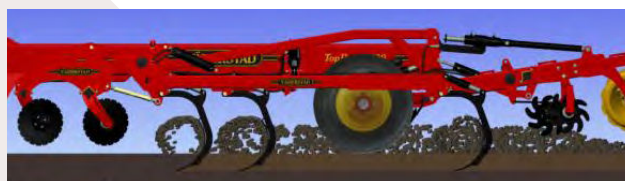
Obrázok 7: Práca s radlicami bez diskov a valca
