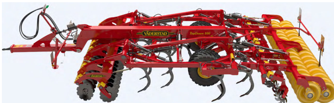
Obrázok 4: TopDown s dvojitým oceľovým valcom Double SteelRunner pre suché ťažké hrudovité pôdy a tiež pre pôdy s vysokou vlhkosťou
