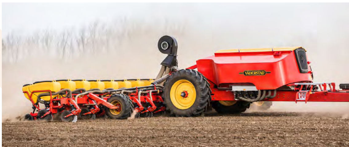
Obrázok 33: Tempo L 16 so zásobníkom hnojiva a aplikátorom mikrogranulátov pri práci
