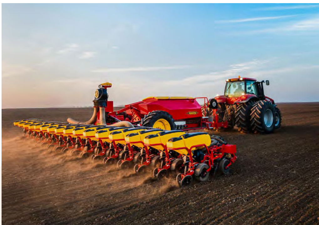
Obrázok 34: Ťahaná presná sejačka Väderstad TEMPO TPL 16 s centrálnym zásobníkom na hnojivo 5000 l
