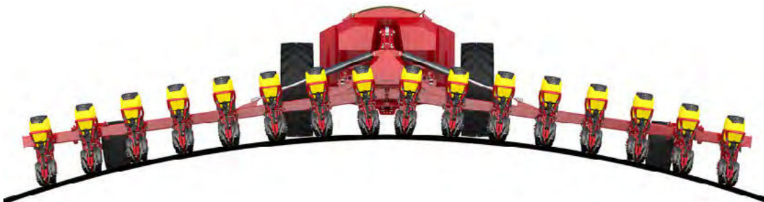
Obrázok 32: Optimálne kopírovanie a dodržanie hĺbky sejby sejačky Tempo L
