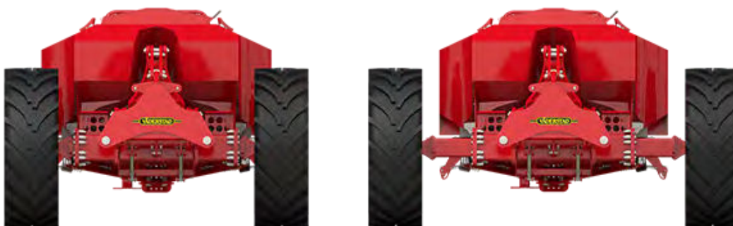
Obrázok 31: Teleskopické nastavenie rozchodu kolies sejačky Tempo L
