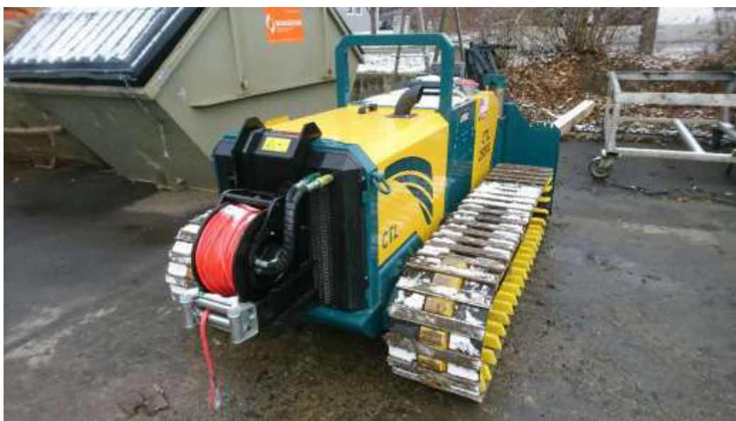
Pohled na trakční naviják vpředu – na něm je nylonové lano, a zezadu na zadní štít + přibližovací naviják
