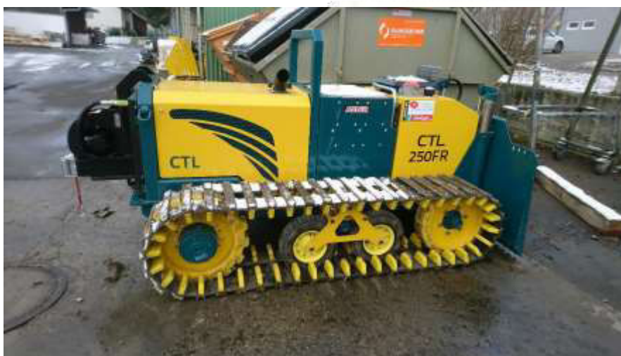
Pohled na trakční naviják vpředu – na něm je nylonové lano, a zezadu na zadní štít + přibližovací naviják
