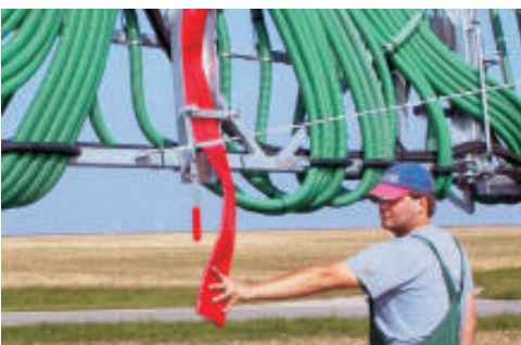
Exacut-Verteiler mit Steinfang
