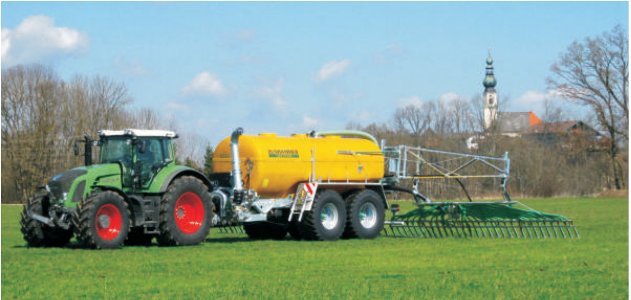
SKE 18500 ECO-DUO mit 18m Farmlandfix Verteiler
