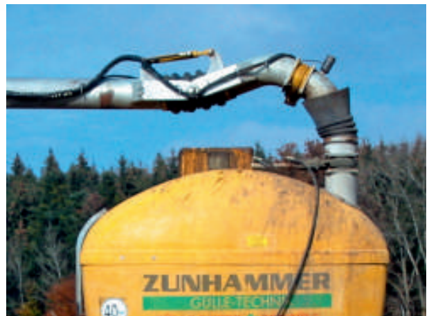
Extremneigung des Elastiktrichters beim Übertanken
