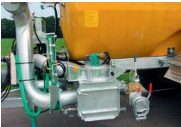
Rotacut mit großem Steinfangkasten
