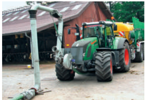
Frontandocksystem an der Güllegrube
