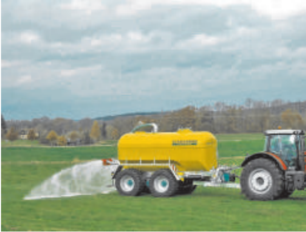
MKE 14000 ECO mit Prallkopfverteiler
