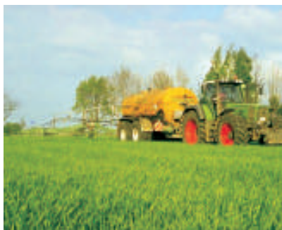
Schleppschlauch in Getreide
