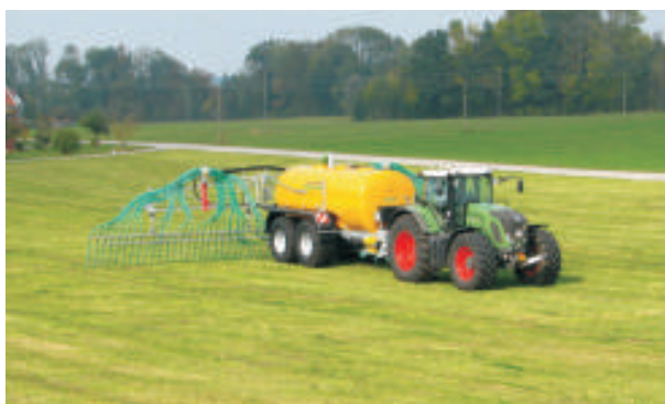
SKE 18500 mit Schleppschlauch
