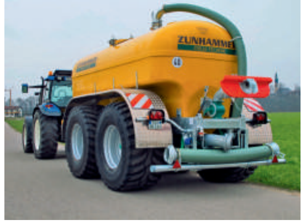
MKE 14000 ECO mit Prallkopfverteiler
