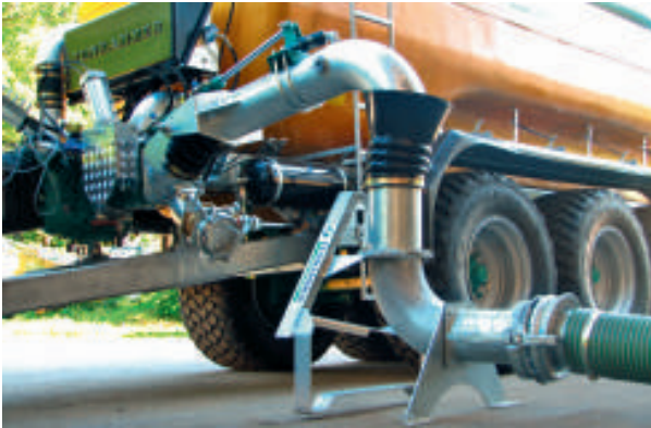
Deichsel-Saugarm HANDY mit Dreifußtrichter
