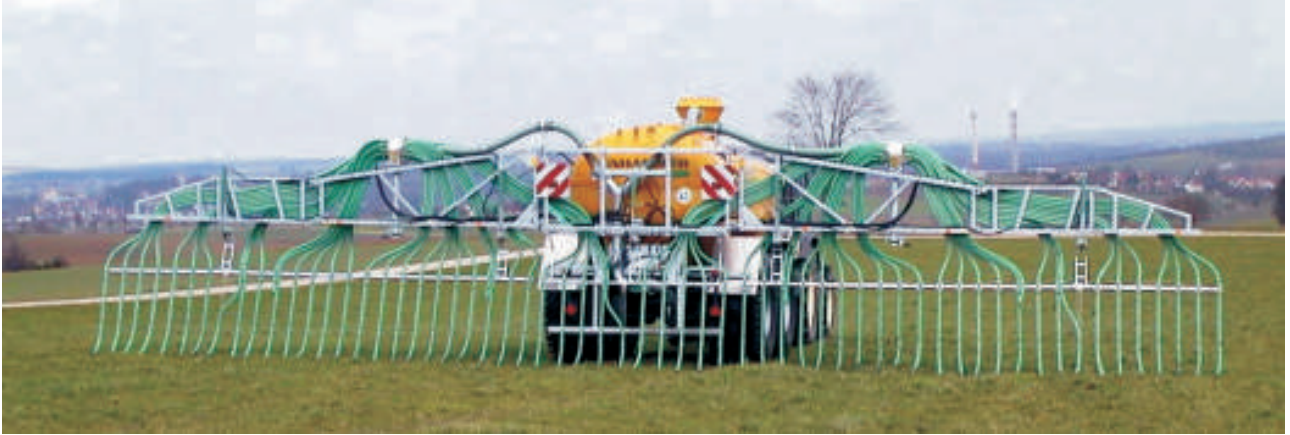
Schleppschlauch Ex30+30 auf 18m Verteilbreite
