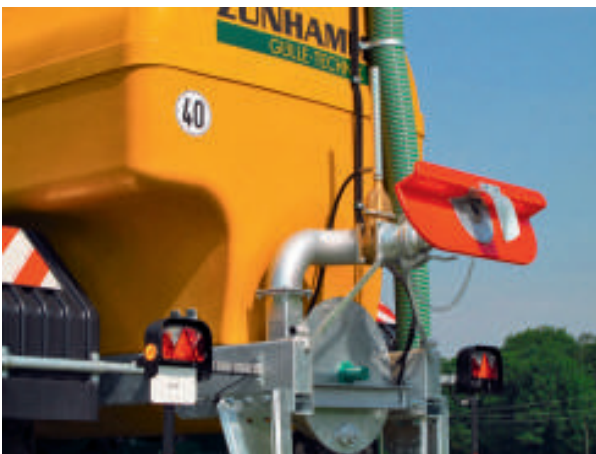
Prallkopf mit Turbine am STS18000KL
