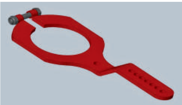
Patent-Lenkhebel (Schematische Darstellung )
