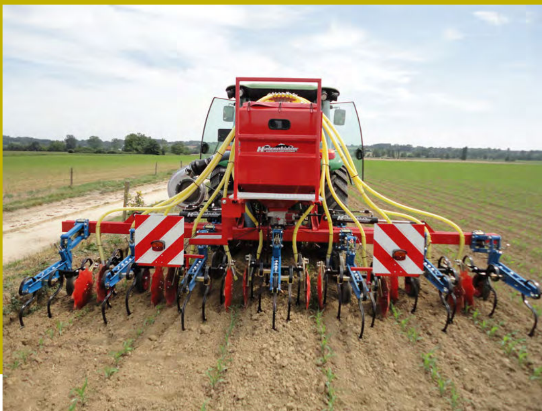
Obrázok 8: 6- radličková sklopná plečka s pneumatickým aplikátorom hnojiva
