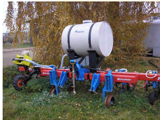
Obrázok 7: 6-riadková radličková pevná plečka s mech. aplikátorom resp. s tekutým prihnojovaním
