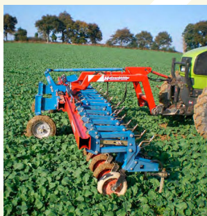
Obrázok 2: Čelné zavesenie pomocou odpojiteľného závesu „Frontanbaubock“. Po jeho odpojení je plečka pripravená na zadné pripojenie
