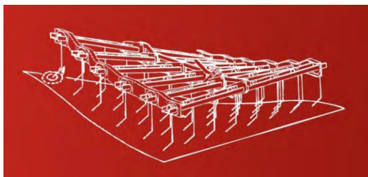
Flexibilné ohybné prúťové polia pre ideálne kopírovanie
