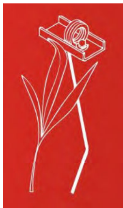
Uloženie pružiny prstov v U-nosníkoch (ochrana rastliny)
