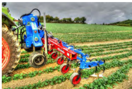
Obrázok 1: Aut. kamerové navádzanie so špeciálnym posuvným rámom na plečke Hatzenbichler
