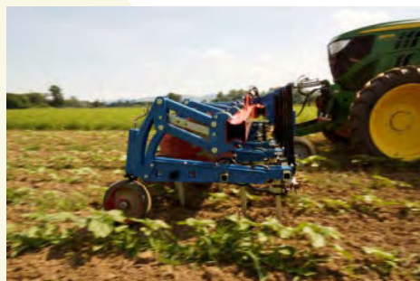
Obrázok 3: Priame pripojenie plečky na čelný záves traktora
