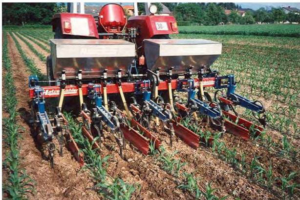
Obrázok 6: 6-riadková radličková pevná plečka s mech. aplikátorom resp. s tekutým prihnojovaním
