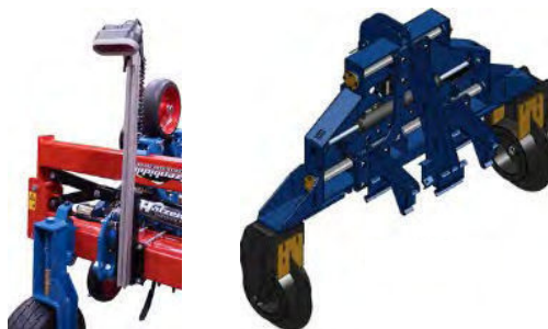
Obrázok 1: Aut. kamerové navádzanie so špeciálnym posuvným rámom na plečke Hatzenbichler
