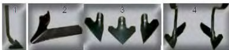
1 – nožíky na cukr. repu, 2 – široké nožíky (300 mm), 3 – nožíky na kukuricu, tekvicu, 4 – nožíky s prihrňiacim krídlom
